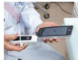
手のひらサイズの超音波診断装置。モニターはスマートフォンサイズで軽量なので、扱いやすい。
