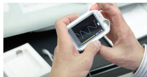
心電図や酸素飽和度計測、体温、血圧測定などの機能を1台に搭載した小型の携帯型マルチヘルスマニター。
