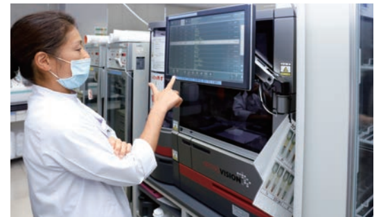
輸血療法に関する血液型・不規則抗体などの検査をする全自動輸血検査装置を使って、迅速に検査を行っている。
